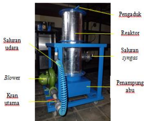
Gambar 3. Konstruksi gasifier
