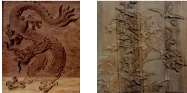
Gambar 9. Hasil ukiran dengan menggunakan mesin router
