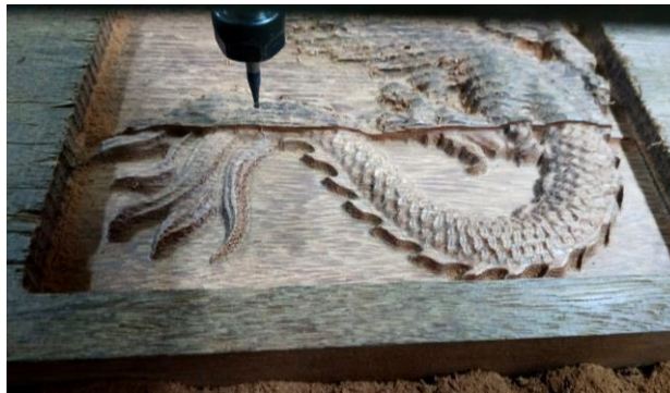
Gambar 9. Proses pembuatan ukiran dengan menggunakan mesin router
