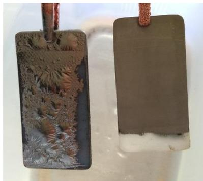
Gambar 4 Hasil elektroplating material ABS yang tidak diamplas (kiri) dan material ABS yang diamplas (kanan)
