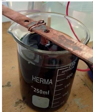
**Gambar 7** Proses katalisasi dengan menggunakan larutan Palladium Stannous Chloride
