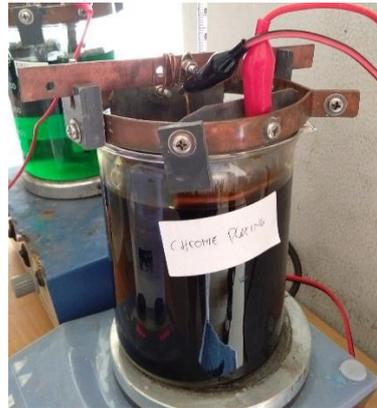
**Gambar 10** Proses elektroplating krom
