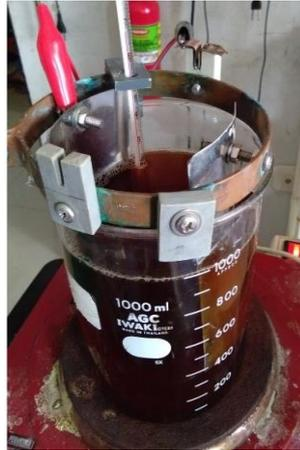
**Gambar 5** Proses *soak cleaning* dengan larutan pembersih
