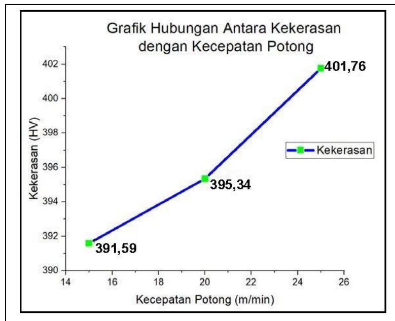
Gambar 8. Pengaruh Kecepatan Potong Terhadap Nilai Kekerasan White Layer yang Terbentuk
