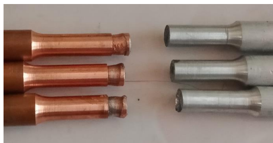
Gambar 4. Spesimen setelah mengalami uji tarik
