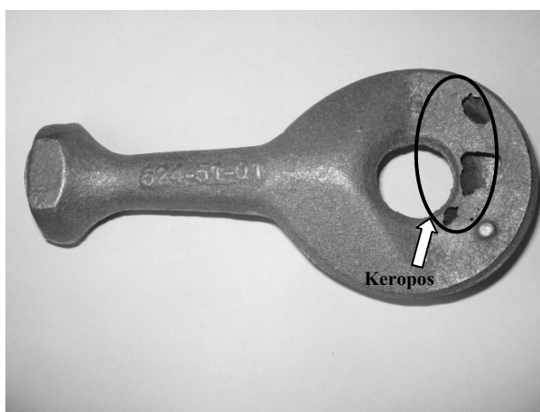
Gambar 6. Rongga udara dalam yang menyebabkan keropos
