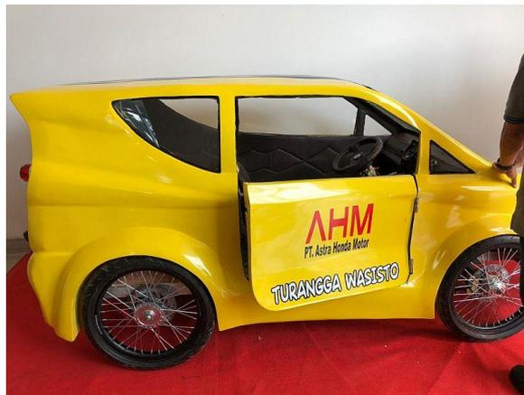
**Gambar 1.** Mobil konsep hemat energi Turangga Wasisto yang dirancang oleh Universitas Mercu Buana [5]
