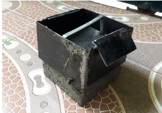
Gambar 4. Proses pelepasan paving block dari cetakan
