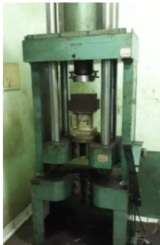
Gambar 5. Alat uji tekan untuk beton
