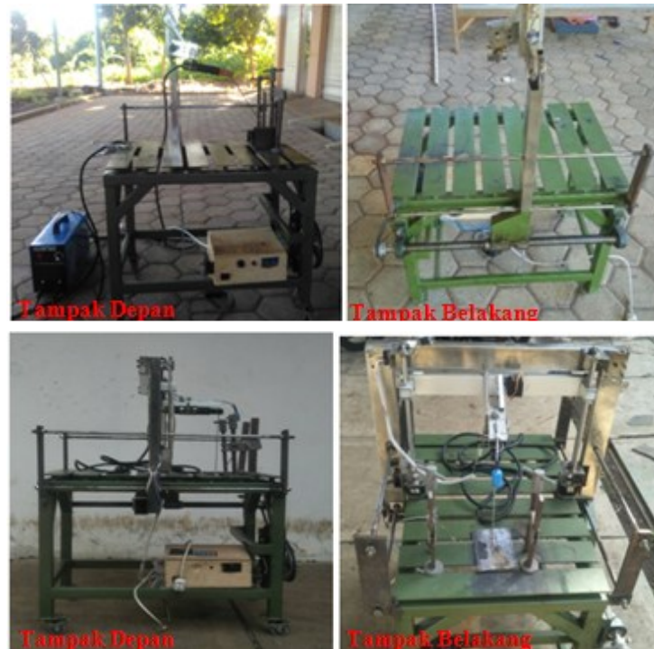
Gambar 1. Jig welding sebelum dikembangkan (atas) dan setelah dikembangkan (bawah)
