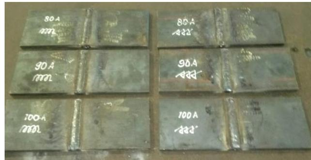
**Gambar 4.** Hasil pengelasan spesimen baja ST41
