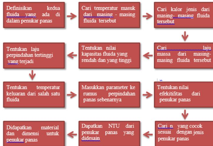
Gambar 5. Diagram skematik prosedur analisis penukar panas
