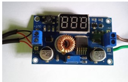
Gambar 2.6 Trafo Step Down
