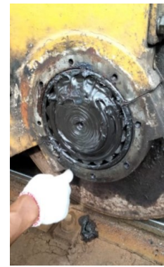
Gambar 10. Kontaminasi pelumas pada bantalan
