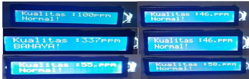
Gambar 5. Tampilan LCD menggunakan sensor MQ-135
