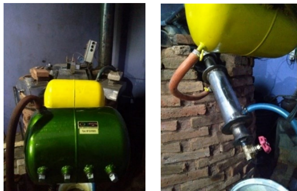
Gambar 7. Tabung kondensat mesin pirolisis 1-proses
