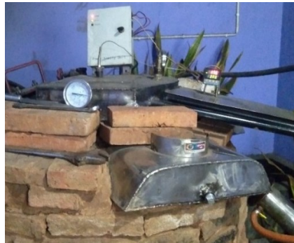
Gambar 8. Tabung Penampung Solar Mesin Pirolisis 1-Proses.
