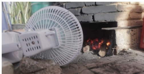
Gambar 3. Ruang Bakar Mesin Pirolisis
