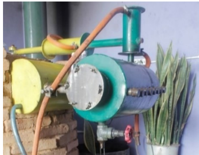
Gambar 6. Tabung Kondensat Mesin Pirolisis 2-Proses.
