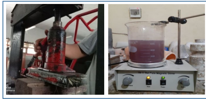
Gambar 2. Proses cetakan komposit dan magnetic stirrer
