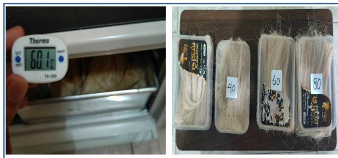
Gambar 1. Proses hot alkali pada serat dan hasilnya
