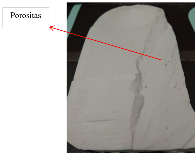
Gambar 6. Porositas Pada Hasil Cetakan Sisipan Sol Sepatu dengan RTV 497 talc 25%
