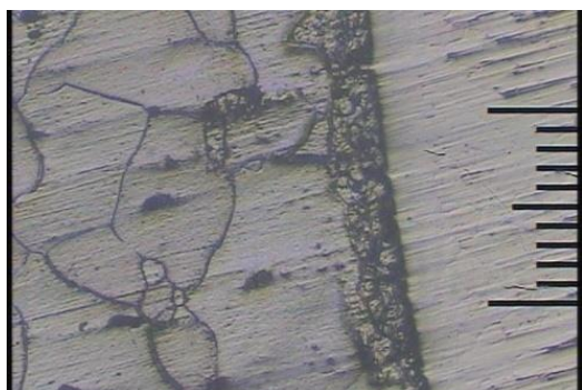
Gambar 7. Batas antara weld metal dengan HAZ baja karbon dengan PWHT 800°C perbesaran 200X
