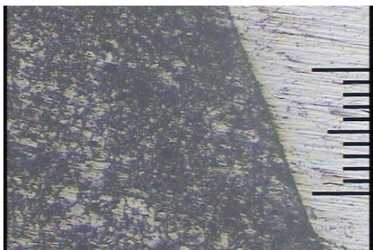
Gambar 5. Batas antara weld metal dengan HAZ baja karbon dengan PWHT 600°C perbesaran 200X
