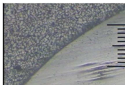
Gambar 3. Batas antara weld metal dengan HAZ baja karbon dengan PWHT 400°C perbesaran 200X
