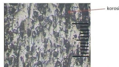
Gambar 18. Bentuk struktur mikro spesimen setelah pengujian Stress Corrosion Cracking dengan pembebanan 40kg.
