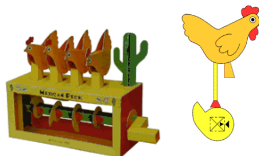
Gambar 2. Contoh mainan mekanikal edukatif dengan mekanisme penggerak “cam-follower”.
