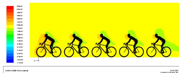
Gambar 11. Perbandingan kontur tekanan statis pada tiap sepeda untuk jarak \frac{1}{4} diameter roda (168,5 mm) dan kecepatan aliran 30 km/jam.
