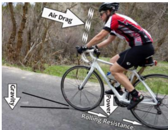
Gambar 3. Gaya yang bekerja pada pengendara dan sepeda [6].
