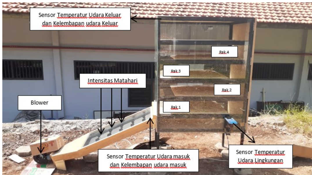
Gambar 1. Alat uji SPD dan tata letak alat ukur pengukuran
