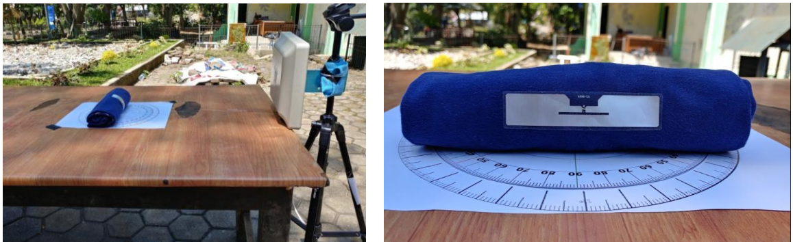
Gambar 4 Layout Pengujian Pengaruh Orientasi RFID Tag terhadap Kemampuan Pembacaan
