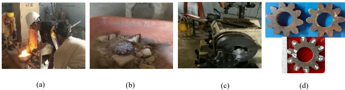
Gambar 3. Proses pembuatan roda gigi (a) pengecoran roda gigi (b) pembersihan sampel roda gigi bebas dari ikatan pasir (c) pemotongan ketebalan roda gigi (bubut) (d) sampel roda gigi yang telah jadi
