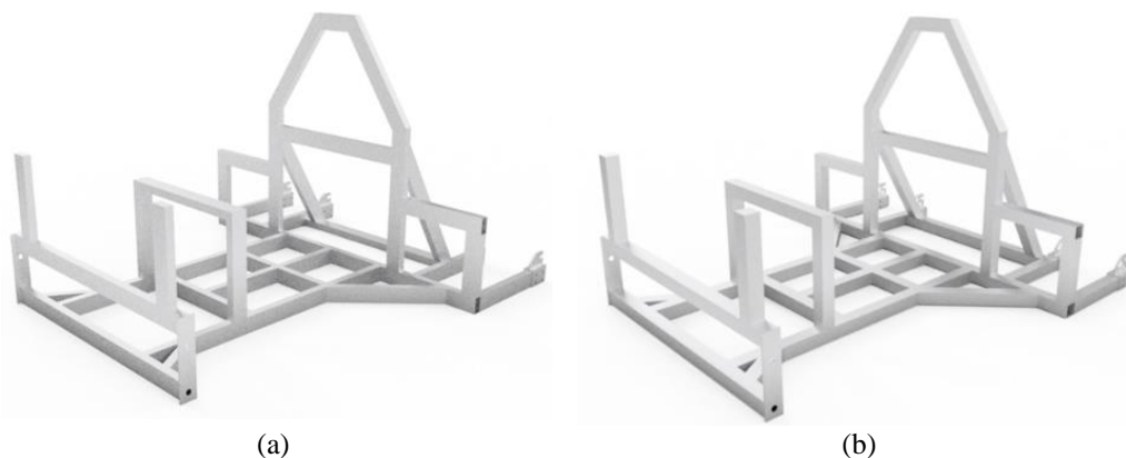
Gambar 1. (a) Desain chassis Profil Rectangular , (b) Desain Chassis Profil Square
