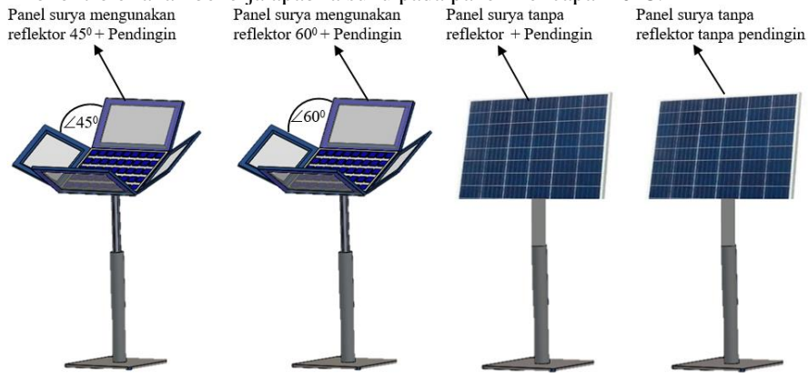
Gambar 2. Panel surya menggunakan reflektor dengan sudut reflektor 45^{\circ} , reflektor dengan sudut reflektor 60^{\circ}
