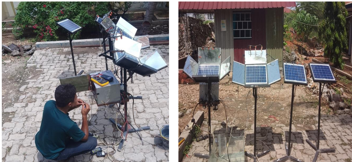
Gambar 3. (a) Proses instalasi sistem pendingin pada panel surya dan (b) Proses pengambilan data
