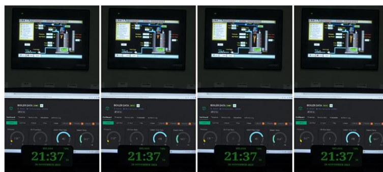
Gambar 12. Pemantauan kecocokan tampilan data pada HMI PLC dengan Platform Blynk
