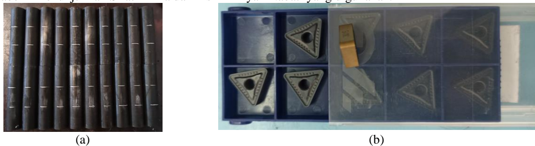
Gambar 1. (a) Material Benda Kerja AISI 4140, (b) Pahat Sisipan Karbida
