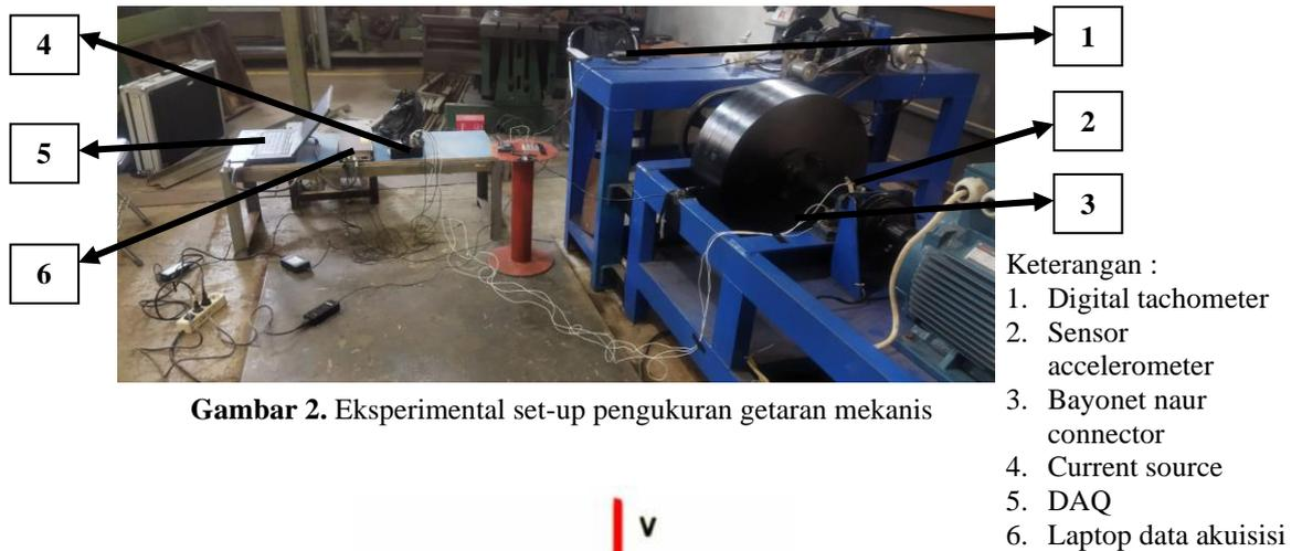
Gambar 2. Eksperimental set-up pengukuran getaran mekanis
