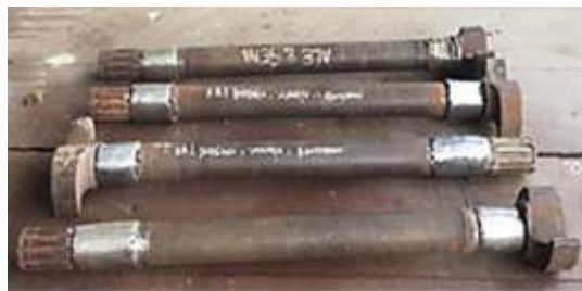
Gambar 4. Bahan uji Cam-Shaft yang telah dilapisi permukaannya dengan material E7016
