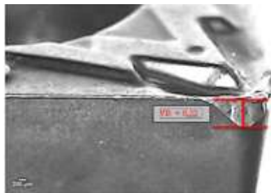
Gambar 6. Mekanisme abrasif pada bidang utama dan geram pahat karbida TiN
