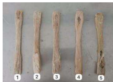
Gambar 8. Pengujian Sampel Laju Korosi
