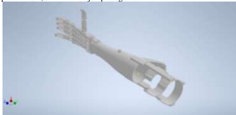
Gambar 2. Konsep Desain 3D Lengan Prostesis Menggunakan Autodesk Inventor 2020
