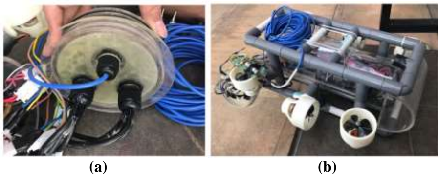
Gambar 5. (a) Penutup cover bagian belakang, (b) hasil akhir perakitan UWROV.
