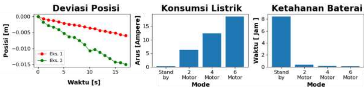
Gambar 8. Data deviasi posisi pada posisi melayang, konsumsi listrik, dan ketahanan baterai.
