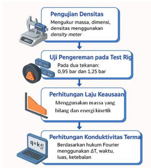
Gambar 4. Diagram alir penelitian *brake pad* berbasis tembaga menggunakan *test rig* berskala
