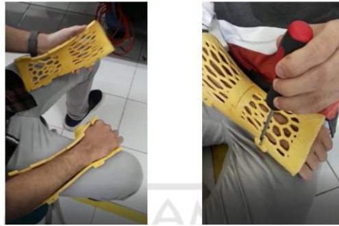
Gambar 8. Hasil Cetak 3D Printer dan Orthosis saat digunakan oleh Pasien
