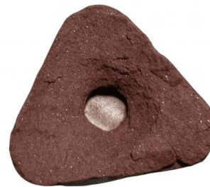
b. Green compact yang mengalami kerusakan struktural
