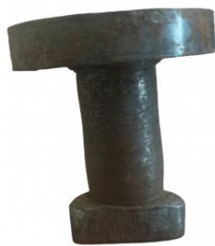
a. Punch yang mengalami deformasi (bending)
