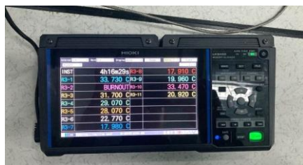
Gambar 2. Alur pengambilan data temperature Rack server menggunakan Hioki LR8450.
