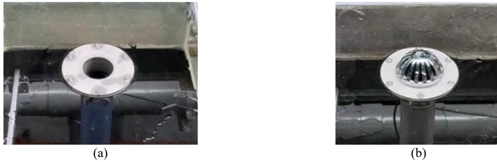
Gambar 3. (a) Foto outlet tipe sharp-edge tanpa roof drain (b) Foto outlet tipe sharp-edge dengan roof drain tipe dome
