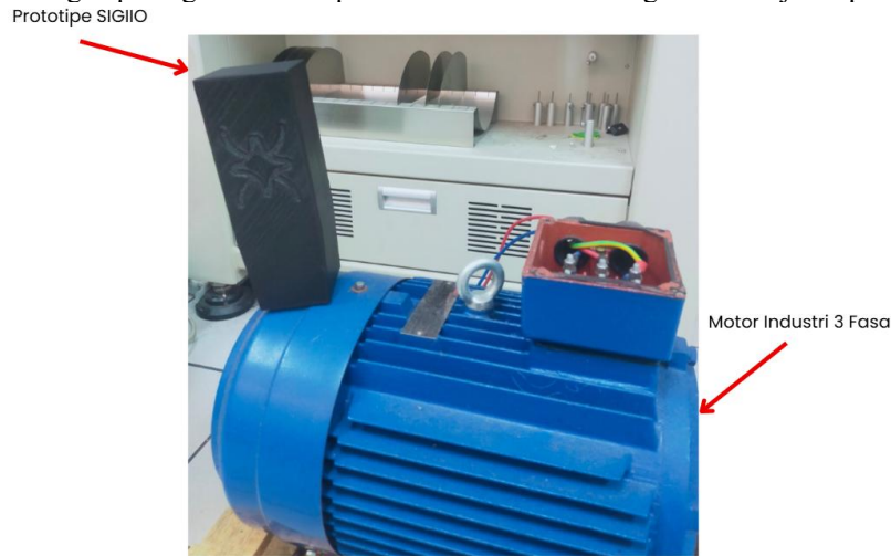
Gambar 7. Ilustrasi pemasangan SIGIIO dalam motor industri 3 fasa
