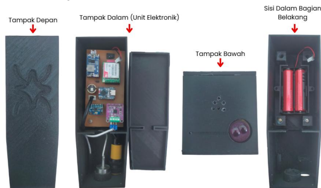
Gambar 5. Hasil perancangan wadah ( enclosure ) modul: (a) Tampak depan, (b) Tampak dalam (unit elektronik), (c) Tampak bawah, (d) Sisi dalam bagian belakang.
