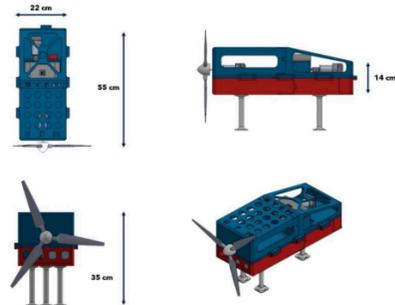
Gambar 2. Desain Alat Peraga Turbin Angin
