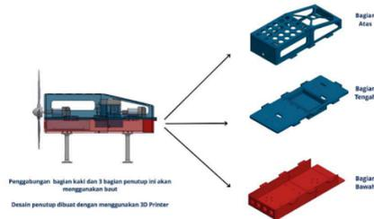
Gambar 4. Struktur Rangka Alat Peraga Turbin Angin
