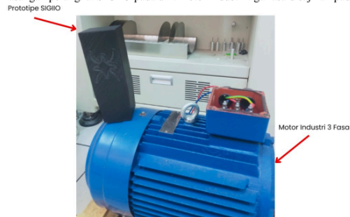
Gambar 7. Ilustrasi pemasangan SIGIO dalam motor industri 3 fasa
