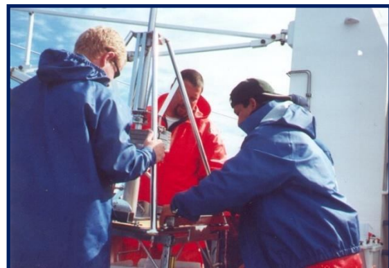
Gambar 2. HAPS corer yang sedang dioperasikan untuk pengabilan sampel sedimen berpasir [5].
