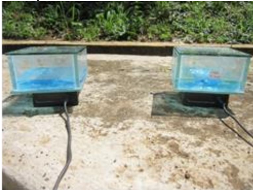
Gambar 1. Pengujian fotodegradasi zat warna methylene blue
