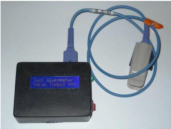
Gambar 3. Hasil pembuatan prototipe divais glukometer non invasive
