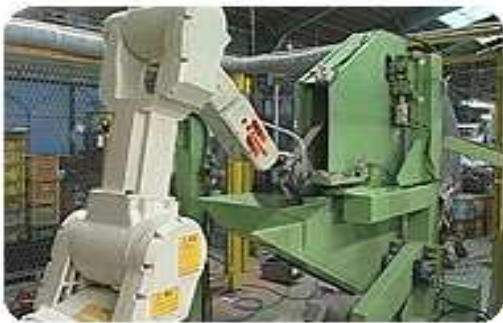
Gambar 13. Robot tipe – F pada proses die casting
