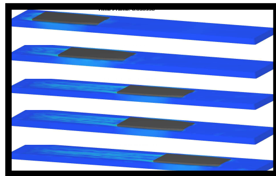
Gambar 3. Simulasi pada CFD dengan kecepatan kapal 1 knot
