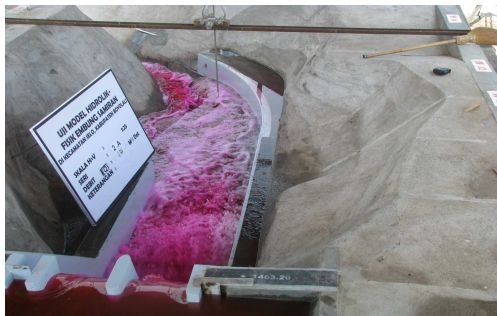
Gambar 9. Bentuk pola aliran di hilir kolam olakan (sungai asli)
