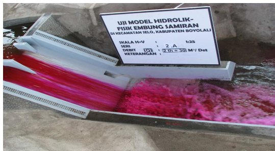
Gambar 15. Pola aliran di kolam olakan pada UMHF seri II A, debit 30 m 3 /det
