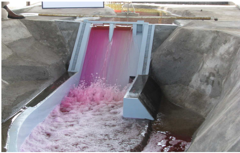
Gambar 2 Bentuk pola aliran di kolam olakan pada debit 55 \text{ m}^3/\text{det} , Seri I (Tes desain)
