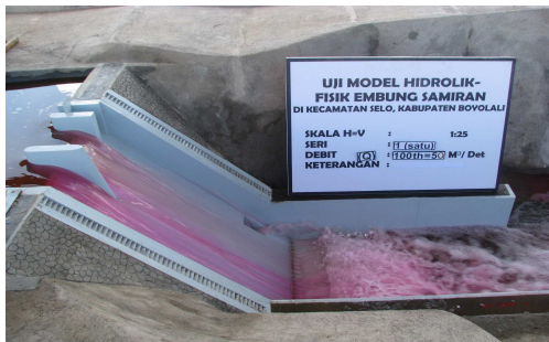
Gambar 3 Bentuk pola aliran di kolam olakan pada debit 50 \text{ m}^3/\text{det} , Seri I (Tes desain)
