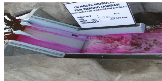
Gambar 17. Pola aliran di kolam olakan pada UMHF seri II B, debit 40 m 3 /det
