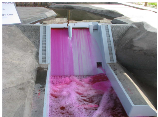
Gambar 7 Bentuk pola aliran di kolam olakan pada debit 20 \text{ m}^3/\text{det} , Seri I (Tes desain)
