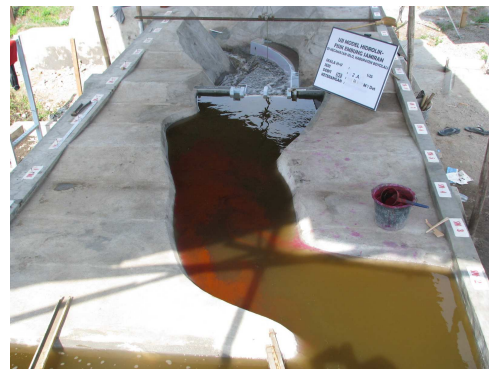
Gambar 1. Bentuk pola aliran di hulu mercu embung
