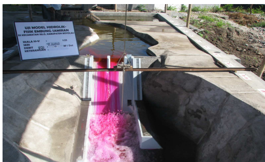
Gambar 4 Bentuk pola aliran di kolam olakan pada debit 45 \text{ m}^3/\text{det} , Seri I (Tes desain)
