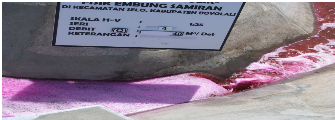
Gambar 21. Pola aliran di bagian hilir kolam olakan
