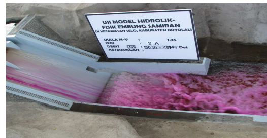
Gambar 16. Pola aliran di kolam olakan pada UMHF seri II A, debit 45 m 3 /det
