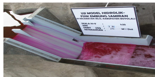
Gambar 18. Pola aliran di kolam olakan pada UMHF seri II B, debit 20 m 3 /det
