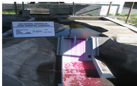
Gambar 8 Bentuk pola aliran di kolam olakan pada debit 10 \text{ m}^3/\text{det} , Seri I (Tes desain)
