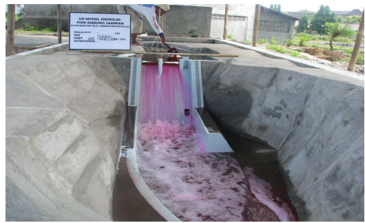
Gambar 5 Bentuk pola aliran di kolam olakan pada debit 40 \text{ m}^3/\text{det} , Seri I (Tes desain)
