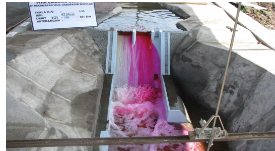
Gambar 12. Pola aliran di kolam olakan pada UMHF seri II, debit
