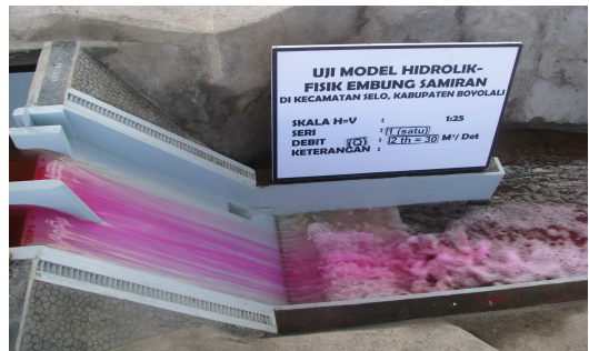
Gambar 6 Bentuk pola aliran di kolam olakan pada debit 30 \text{ m}^3/\text{det} , Seri I (Tes desain)
