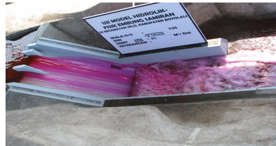
Gambar 13. Pola aliran di kolam olakan pada UMHF seri II, debit 50 m 3 /det
