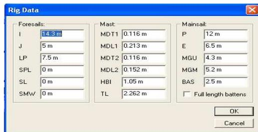
Gambar 3. Tampilan rig data pada *software Span versi 11.12*
