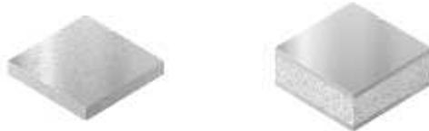
Gambar 1. Konstruksi *Single Skin* dan *Sandwich*
