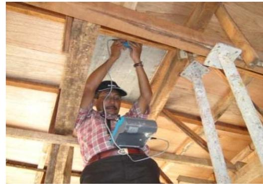
Gambar 6. Pengukuran dengan Profometer
